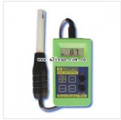
便携式土壤电导率仪和TDS测试仪- SM301 品牌: 米克Milwaukee 价格: 1330 0-1990 \mu S/cm. 10 \mu S/cm
