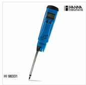
手持式土壤电导率测定仪- HI98331 品牌: 哈纳HANNA 价格: 1100 HI98331用于土壤电导率的直接测定,可同时测量电导率和温度.
