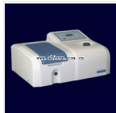
可见分光光度计- 723PC 品牌: 上海 价格: 7850 光谱带宽: 4nm 波长: 325-1000±1 nm
