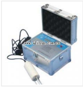
土壤水分速测仪- TSZ-1 品牌: 湖北 价格: 4860 量程: 0-75% (m 3 /m 3 ) 测量精度: 0-50%范围内±2%
