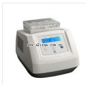
恒温混匀仪- MSC-100 带制冷功能 品牌: 浙江 价格: 14800 控温范围: 0 C ~ 100 C 振荡幅度与方式: 2mm (水平回转)
