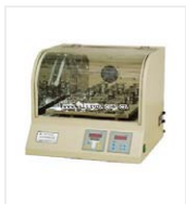
振荡器- ZD-810 品牌: 上海 价格: 4320 工作室尺寸: 370×320mm 振荡频率: 0~280rpm
