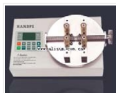
瓶盖扭力测试仪- HB-50 品牌: 杭州汇尔 价格: 0 峰值时测量范围: 0.002~5.00 N.m
