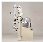
旋转蒸发器-RE-5210 品牌: 上海 价格: 22800 升降台: 手动升降 旋转速度: 转数数显, 20-138转/分
