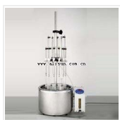
沙浴氮吹仪-SD-12 品牌: 浙江 价格: 9800 温度范围: 室温~100 C (数显) 加热方式: 恒温沙浴
