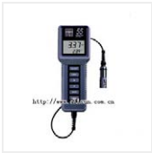
便携式溶解氧测定仪- YSI55-25 品牌: 金泉YSI 价格: 11900 溶解氧 0至200%空气饱和度 温度 -5 C至+45 C
