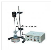
恒温电动搅拌器- JJ-3 品牌: 江苏 价格: 1040 电源: 220V 50Hz 电机: DC 12V
