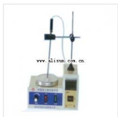
恒温磁力搅拌器- 78HW-1 品牌: 江苏 价格: 650 电机功率: 25W 热丝功率300W
