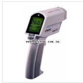
红外测温仪- MX2C 品牌: 雷泰 价格: 14600 测温范围: -30^{\circ}\text{C} \sim 900^{\circ}\text{C} 精度: 读数的 \pm 0.75\% 或 \pm 1^{\circ}\text{C} , 取最大值
