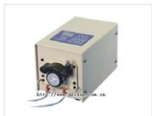
基本型蠕动泵- BT50-1J 品牌: 兰格 价格: 1800 显示转速范围: 0.1~50.0 rpm 正反转可逆 转速分辨率: 0.1 rpm
