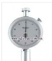
邵氏硬度计- LX-C 品牌: 杭州汇尔 价格: 500 最大量程: 100 HW 压针头部尺寸: SR2.5mm
