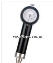
土壤硬度计- TYD-1 品牌: 日本竹村 价格: 2600 硬度指示范围: 0 ~ 40 mm , 0 ~ 500 Kg/Cm2
